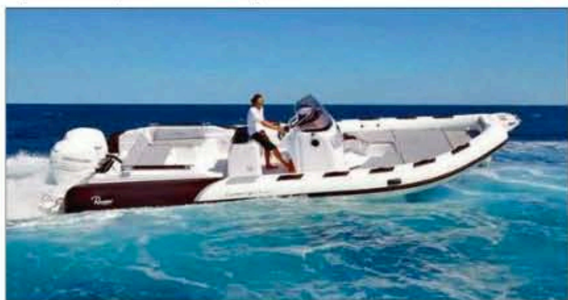
• 28 Sport Touring. Prix: 76 800 € sans moteur – Long.: 8,55 m – Larg.: 3,40 m Homol.: cat. B/20 pers. – Poids: 1 750 kg – Mot. mini: 250 ch – Mot. maxi: 2 x 250 ch Capacité carburant: 450 l
